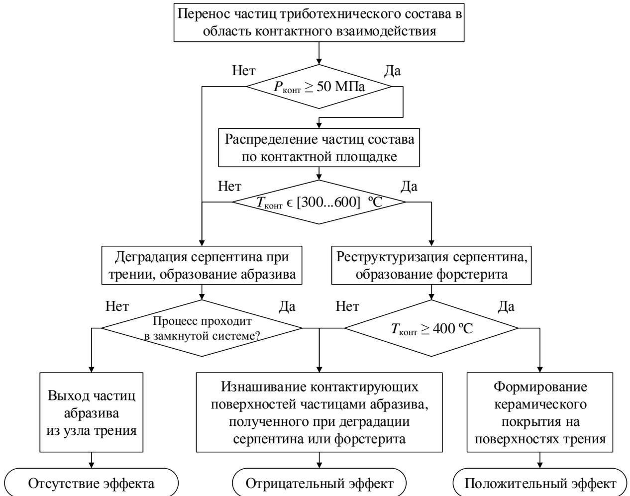
Рисунок 1.3 – Блок-схема процесса формирования покрытия
